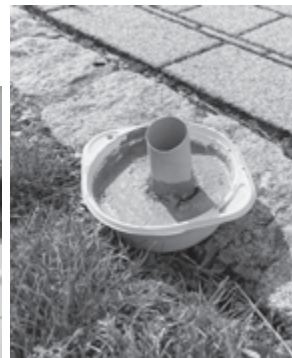
Mit Klopapierrollen wurden Abschussrampen für Raketen betoniert.
